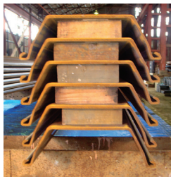
鋼矢板の置き方の例
