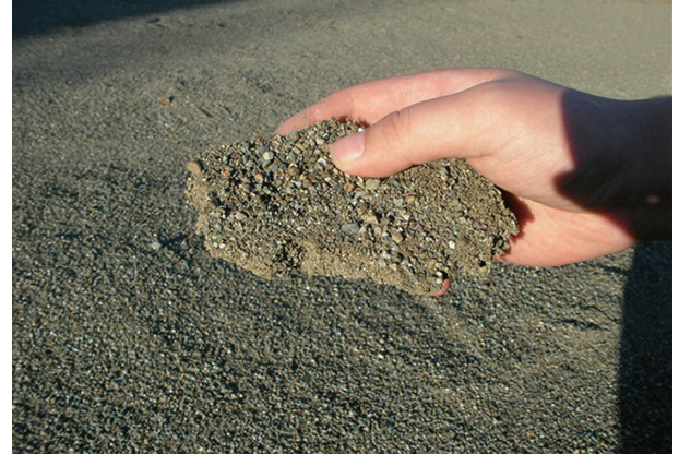
土壌表層面に皮膜が形成され、土壌粒子が結合し粉塵を抑制
