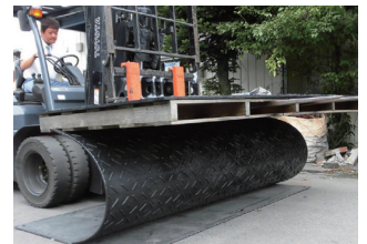
180°の曲げ試験でも割れずに容易に元に戻る
