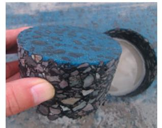
「ポーラス・ファイブ」は、一般的な透水性舗装の弱点であった耐久性を強化し、カラー表面処理を付加した舗装技術。その耐久性によりランニングコストが抑えられ、車走行での舗装面の石の飛散が抑制でき、第三者への事故防止にもつながる。
