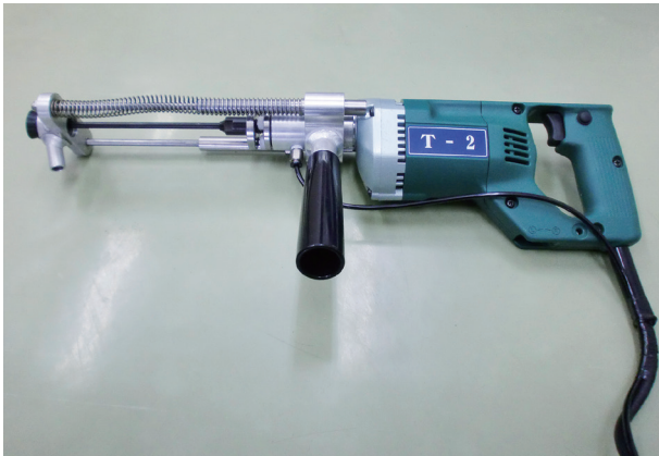
FST 工法 T-2 ドリル
