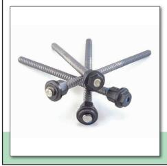
「スクリュープレート工法」はねじ節鉄筋の端部に定着金物を取り付け、グラウトにより固定しコンクリート中に定着させる工法である。コンクリート中に鉄筋を定着させるために設けられた標準フックを特殊な定着金物に置き換えることにより、鉄筋量を減らしコスト低減や施工性向上を図る。従来、鉄筋の先端は定着強度を確保するため折り曲げる必要があった。しかし、この技術を使用することで鉄筋の折り曲げ作業を省略することが可能となった。
