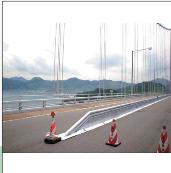
ミニガードシステムは、道路工事等の作業帯で、安心して作業ができるスペースを確保するための移動式ガードレールである。製品の剛性が高く柔軟な継手構造を持つため、安全性に優れる一方、軽量であるため迅速な組立・解体が可能。機能的かつ見た目の美しさも兼ね備えている。[特長]①賃貸（リース）商品のため再利用可能で経済的。②1エレメントが軽量（49.8kg）であるため、重機を必要とせず、人力での組立・解体が可能。③本体のスカート部分が衝突後の車両を正しい走行方向へと誘導する。また曲線で構成されたボディは、現場での見た目も美しい。
