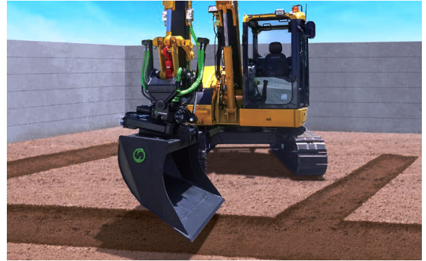
ローテーション機能 (バケットが360°回転するので、縦・横掘、斜め掘などあらゆる方向ですき取りが可能に)
