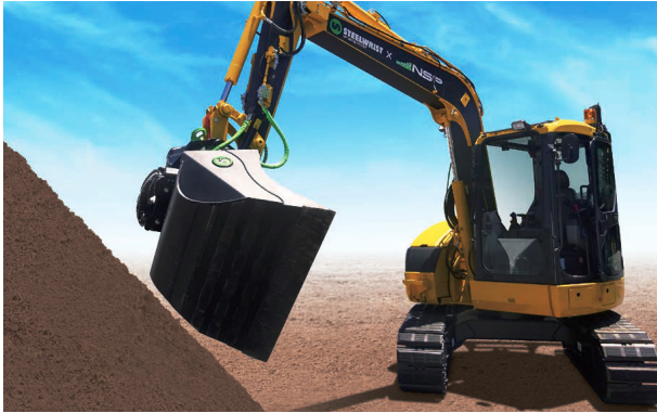
チルト機能 (バケットが左右に最大45°傾くので、法面に建機を正対しなくても整形が可能に)
