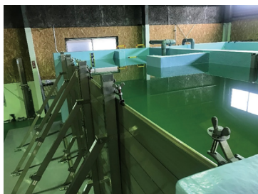
止水パネル高さ2.0m設置時での大型試験水槽
