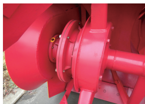
運転室内操作復帰型オーガシャーピンレス装置 (油圧クラッチ式)
