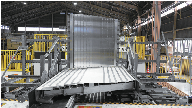
振動台試験装置
