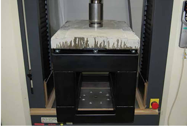
はく落防止対策性能照査試験
