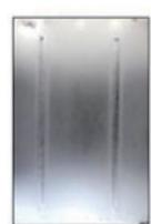
SUS304 (2B材) を電解により不動態化処置
