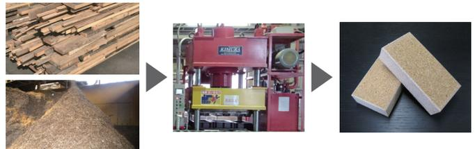
間伐材・廃材などを再利用して得られる自然由来の環境に優しい原料を、蒸気噴射式300tプレス機により圧縮成型。曲げ強度10N/mm<sup>2</sup>の高密度荷重製品となる。
