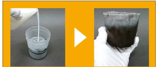
水を取り込んでゲル化し、地山側に遮水壁を作る
