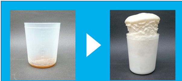
水と反応・発泡し、その膨張圧で水路をふさぐ
