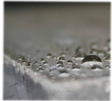
塗布後水弾き状況
