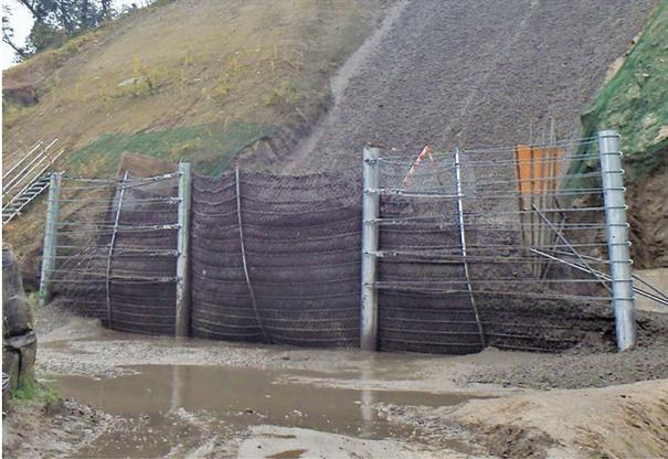
実物大実験での土砂捕捉事例
