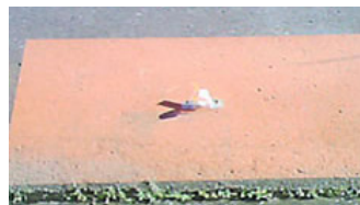
サーモグラフィー試験状況 (アスファルトの上にK-グランドコートを塗布)
