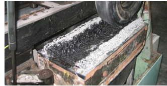
従来型特殊合材装置の場合 損氏60度、100サイクル後 3cmに達する程度の わだち掘れが発生。
