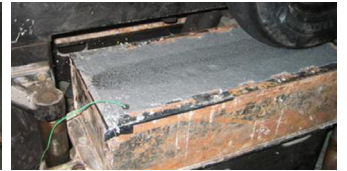
PAジョイント®の場合 損氏60度、30,000サイクル後 でもわだちや変形が まったく生じない。
