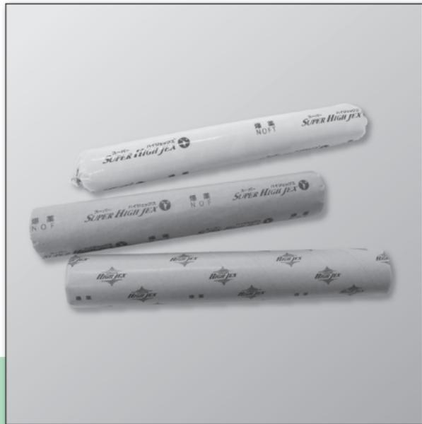
「スーパーハイジェックス」はダイナマイトの代替品として使用できる高威力含水爆薬。配合成分中にニトログリセリンを含んでいないため、衝撃や摩擦に対して安全である。また、ダイナマイトと比較して低温起爆感度が優れているほか、貯蔵面においても1年後の安定度試験が不要である。取扱は通常の含水爆薬と同様であり、水孔または湧水箇所での使用にも性能が低下せず作業性に優れているほか、使用時に発生する後ガスも良好である。包装形態はプラチューブと紙巻の2種類あり、現場状況に応じて選択可能である。
