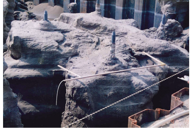
大規模野外注入試験によるハイブリッドシリカの浸透固結体
