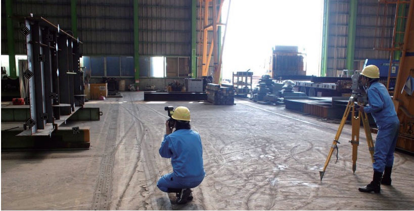
計測状況の比較 (左：PIXXIS2計測、右：トータルステーション計測)
