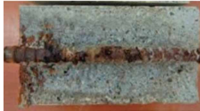
無塗布 鉄筋に腐食が見られる
