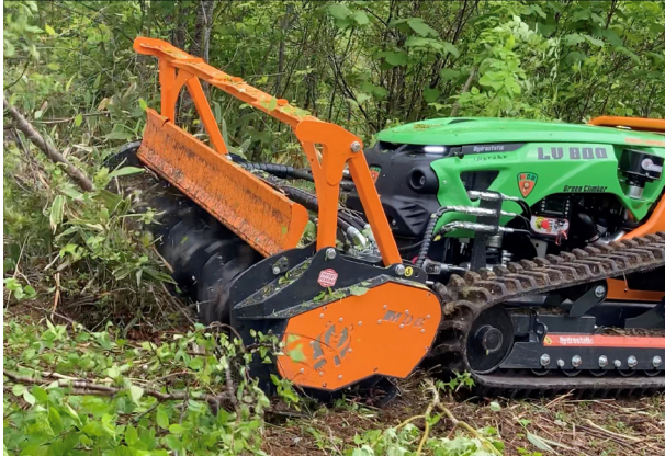
急斜面の雑木から根株の粉碎処理に対応可能
