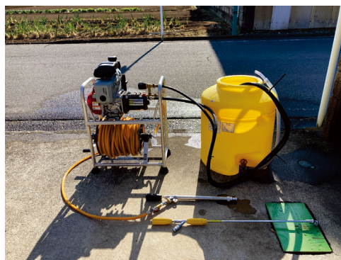
動力噴霧器とタンク、ノズル
