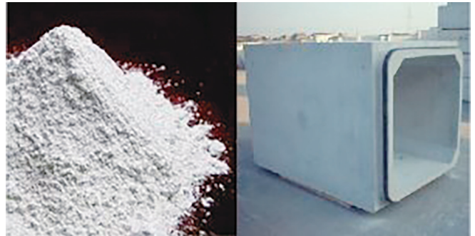
セメントを高炉スラグ微粉末に置き換え CO 2 排出量の45%削減
