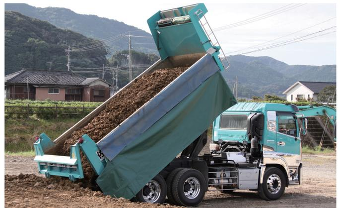
運転席でシートの開閉が可能 / ダンプ稼働状況 (特注防水シート装着)
