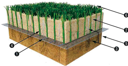
①基布 ②珪砂充填材 ③天然芝の根 ④人工ファイバー ⑤トップの土壌 ⑥天然芝
