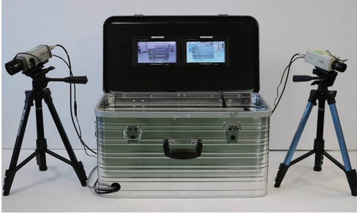
システム構成品（監視カメラ2台、収納ボックス）
