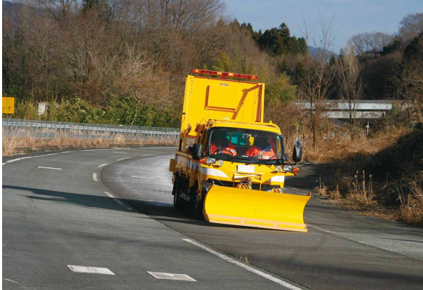
多目的道路維持作業車冬仕様：スノープラウ装着
