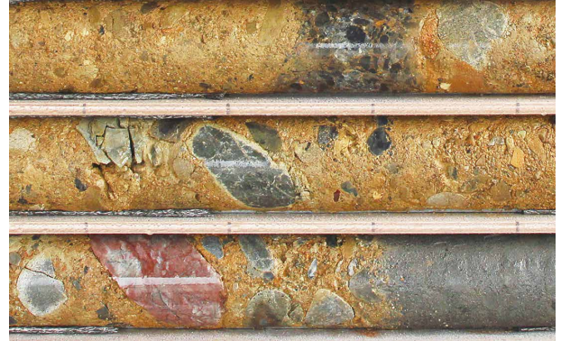
QSボーリングで採取したコア (多様な土質を不攪乱でコア採取可能)
