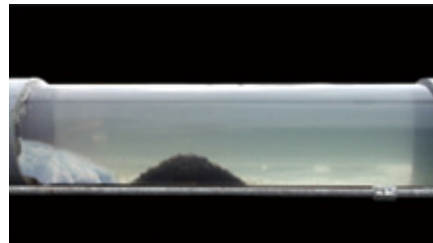
①注入されたアイスピグが夾雑物に到達
