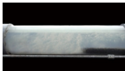
③アイスピグの移動により夾雑物を除去
