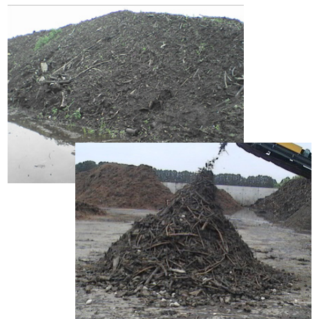
木質混合土砂と分別作業
