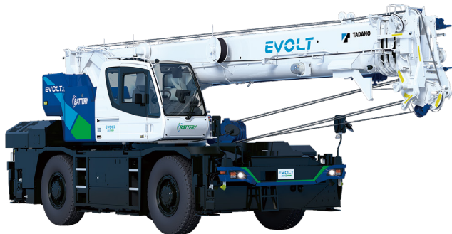
世界初フル電動ラフテレーンクレーン EVOLT eGR-250N
