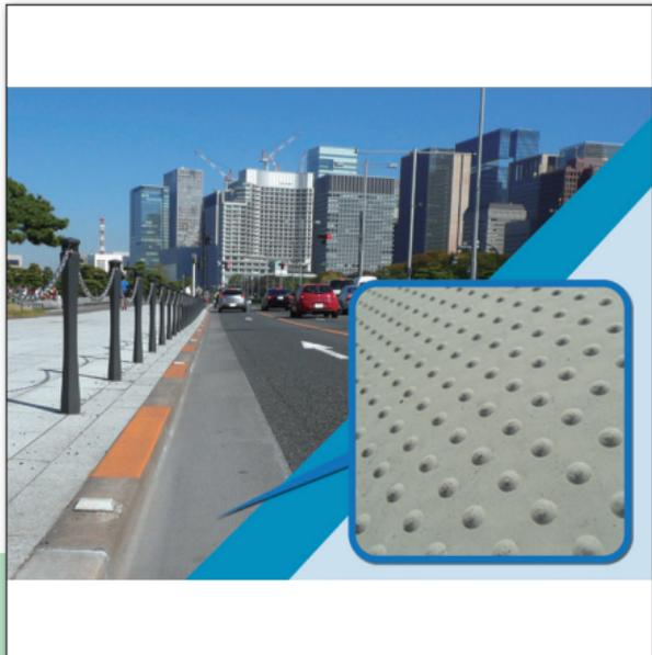
表面特殊加工された型枠により、表面に均一で微細な突起形状の施されたコンクリート製品。[特長]①安全性：従来品と比べ、滑り抵抗値の増大と反射光の抑制。②安心感：視覚的にも体感的にも滑りにくい安心感を付与。③品質：比表面積の増大により収縮時などの亀裂が抑制され、コンクリート製品特有の色むらも目立ちにくい。④意匠性：整然と並んだ微細な突起が上質感を付与。⑤施工性：製品規格を含め従来製品と同等。⑥耐久性：車両通行のない歩行のみの既設箇所での追跡調査では10年以上突起部の機能低下なし。また塗布剤などによる表面硬度の向上も可能。[適用箇所]基本的に型枠面であれば型枠改造などにより製作可能。
