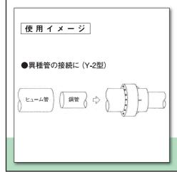
「Yスリーブ継手」は、接続しにくい異種管同士を直接つなぐことができる継手。相手管の外径に合わせて製作されるため、石綿管のように管種が複雑なものにも対応可能である。水密性や伸縮性に優れ、農業用水を中心に多くの実績があり、特に石綿管、ヒューム管等の補修用として活用されている。
