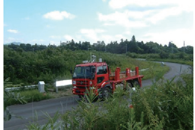
(独)土木研究所 舗装走行実験施設での載荷試験風景
