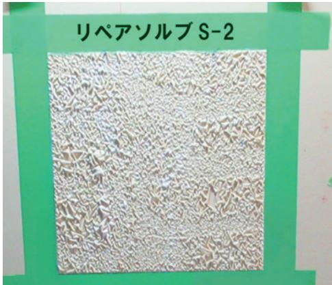
剥離剤が塗膜に浸透し浮き上がった状態
