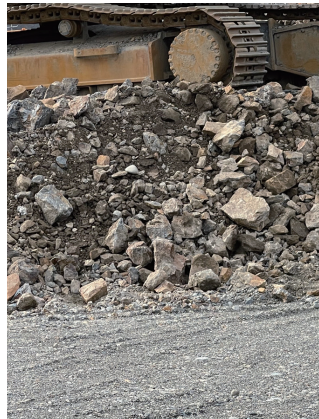
重金属含有岩石ズリを安全な盛土材に改良
