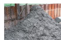
泥土圧シールド泥土
