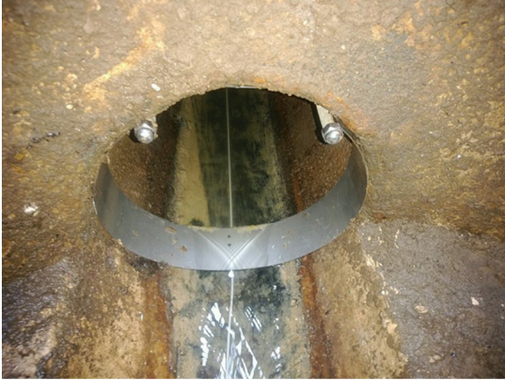
管内の下水温度を光ファイバーで連続測定
