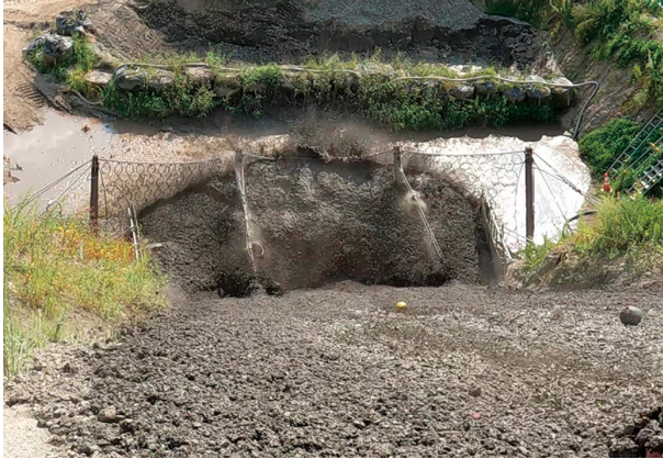
実物大実験での土砂捕捉事例
