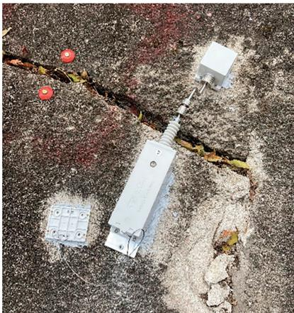
モルタル吹き付け斜面のクラック変位を計測
